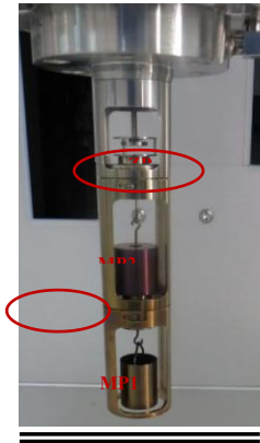
图 8 磁悬浮天平运行构造示意图
